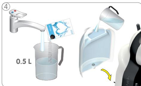
4 Mescolare 0,5 l di acqua con il contenuto di una busta di soluzione decalcificante liquida. Versare la soluzione decalcificante nel serbatoio dell'acqua e inserirlo nella macchina.
