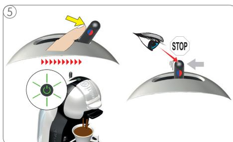
5 Muovere la leva verso destra per la preparazione di bevande calde, e verso sinistra per la creazione di bevande fredde. La preparazione della bevanda inizia. Aspettare che la leva ritorni alla posizione iniziale e l'erogazione si fermi automaticamente. l'erogazione può essere fermata manualmente riportando la leva in posizione centrale.
