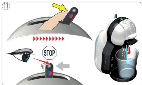
11 Spostare la leva verso destra per iniziare il risciacquo. Aspettare che la leva ritorni alla posizione iniziale e l'erogazione si fermi automaticamente.
