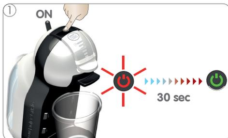
1 Accendere la macchina. Il pulsante di accensione e spegnimento inizia a lampeggiare in rosso quando la macchina si sta scaldando per circa 30 secondi. In seguito il pulsante si fissa sul verde e la macchina è pronta per l'uso.
