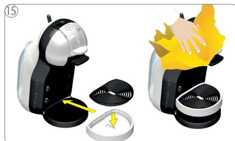
15 Posizionare la griglia raccogliogocce sul vassoio raccogliogocce. Inserire in seguito il vassoio raccogliogocce nella posizione desiderata. Pulire la macchina con uno straccetto umido. Asciugarla in seguito con uno straccetto asciutto.
