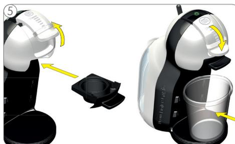
5 Aprire la leva di blocco e inserire il supporto per capsule vuote. Chiudere la maniglia di blocco. Collocare un recipiente vuoto da 1 litro sotto l'erogatore.
