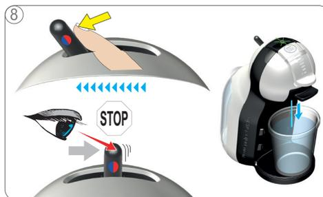
8 Spostare la leva a sinistra. La macchina decalcifica in modo continuo. La leva torna nella posizione iniziale.
