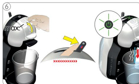
6 Selezionare il massimo livello sul display a barre. Spostare la leva di selezione a destra per iniziare il ciclo di pulizia.
