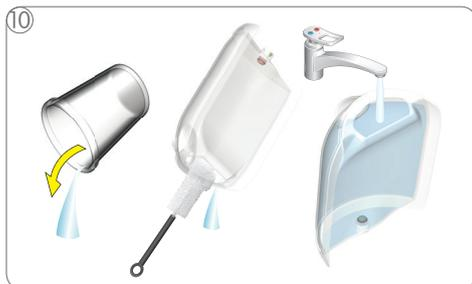
10 Svotare e pulire il recipiente. Risciacquare e pulire il serbatoio dell'acqua. Riempirlo in seguito con acqua potabile fresca e inserirlo nella macchina.
