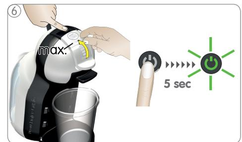
6 Spingere la barra di selezione dell'erogazione fino al livello massimo di tacche. Premere e mantenere premuto il pulsante di accensione e spegnimento per almeno 5 secondi. Il pulsante di accensione e spegnimento inizia a lampeggiare in verde e la macchina passa alla modalità di decalcificazione.
